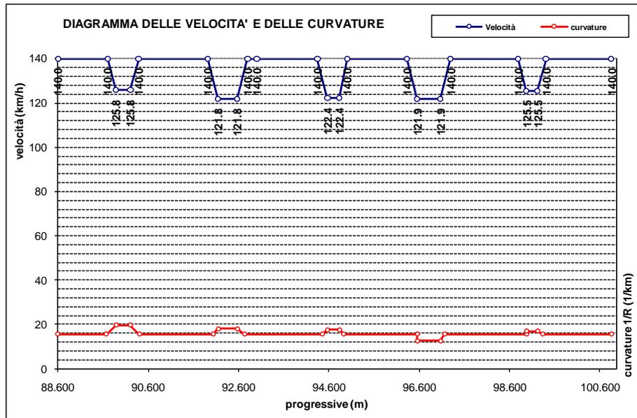
Figura 10-2. Asse esistente: diagramma delle velocità carreggiata Padova
