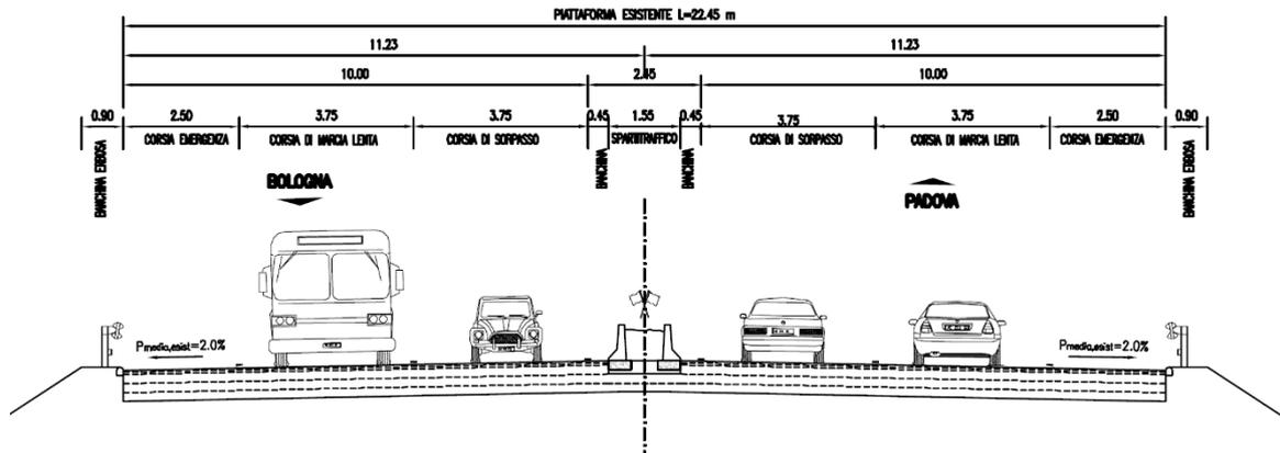
Figura 10-1. Sezione tipo esistente in rilevato
