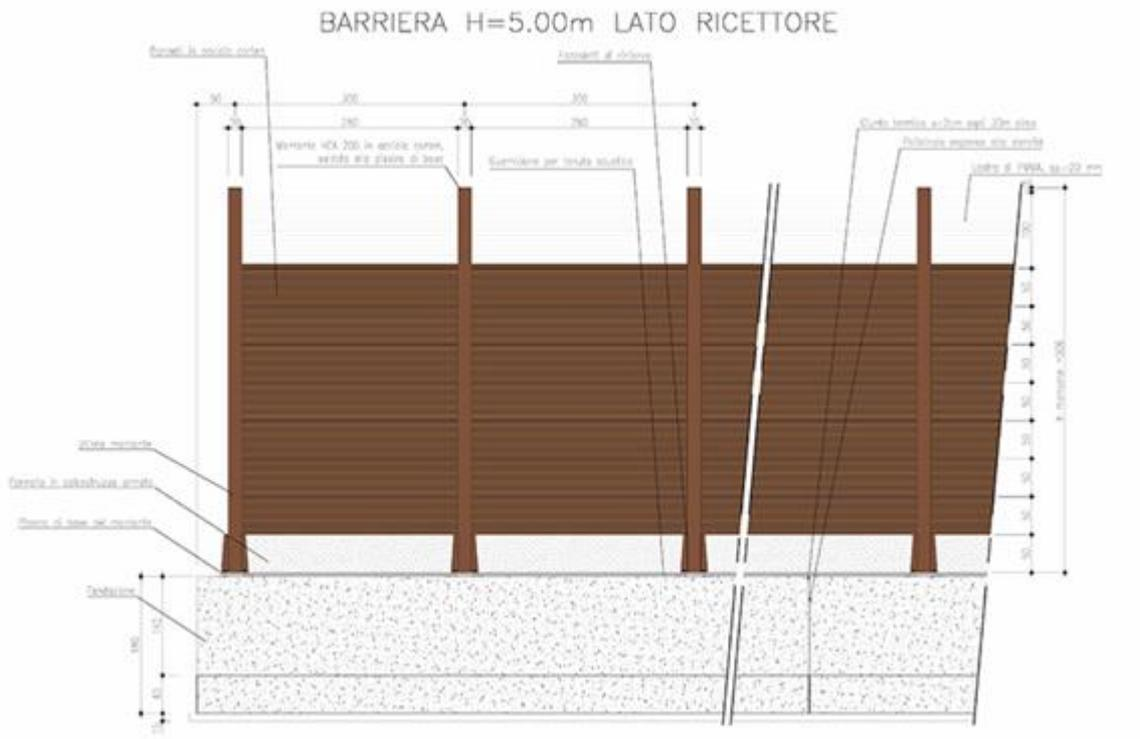
Figura 11-55. Barriere acustiche standard di altezza 5 m previste nel Progetto Definitivo pubblicato in VIA
