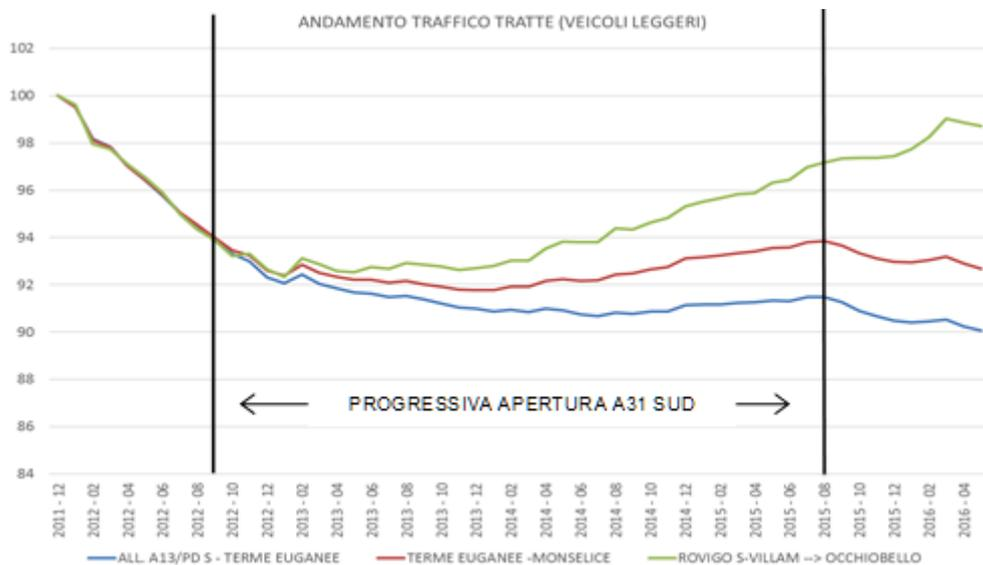
Figura 4-4. - Andamento del traffico sulle tratte dell’A13 a nord e sud della connessione con la A31 Valdastico Sud
