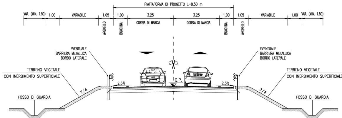
Figura 11-13. Sezione tipo in rilevato – Cat. F2 extraurbana locale
