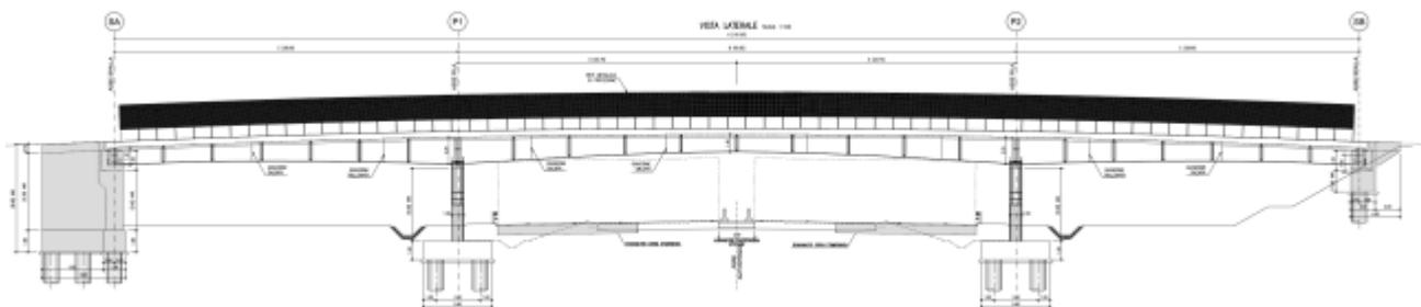
Figura 11-40. Prospetto cavalcavia a tre luci
