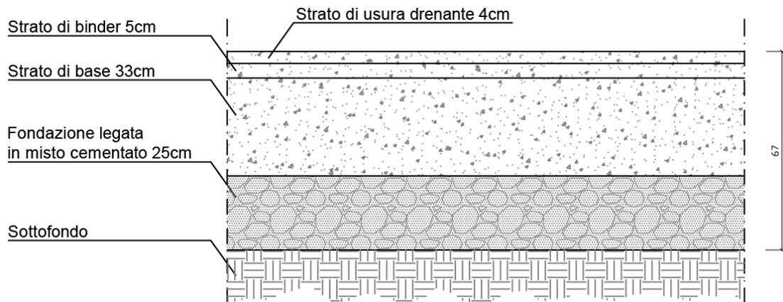
Figura 11-52. Sovrastruttura prevista nei tratti con risanamento RP2 (TIPO 2B)
