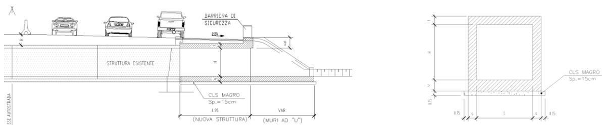
Figura 11-44. Tombini scatolari – sezione trasversale e longitudinale
