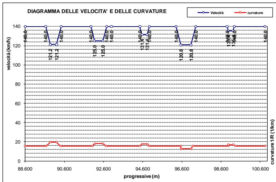
Figura 10-3. Asse esistente: diagramma delle velocità carreggiata Bologna
