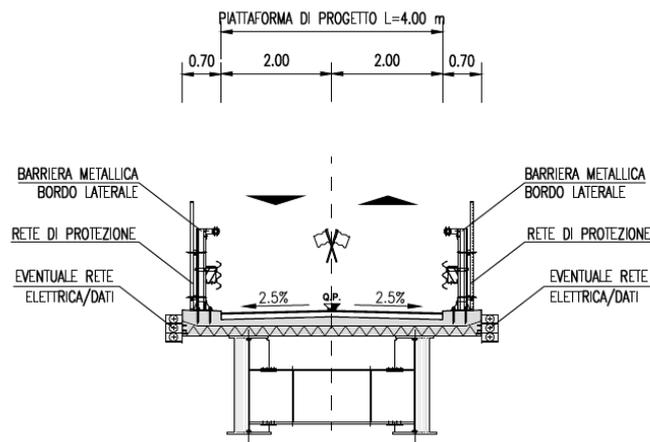
Figura 11-18. Sezione tipo su opera d'arte – Strada a destinazione particolare
