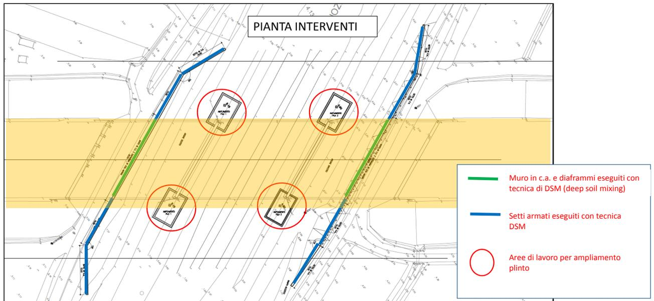
Figura 8-2- Ponte Canale Vigenzone – Pianta interventi
