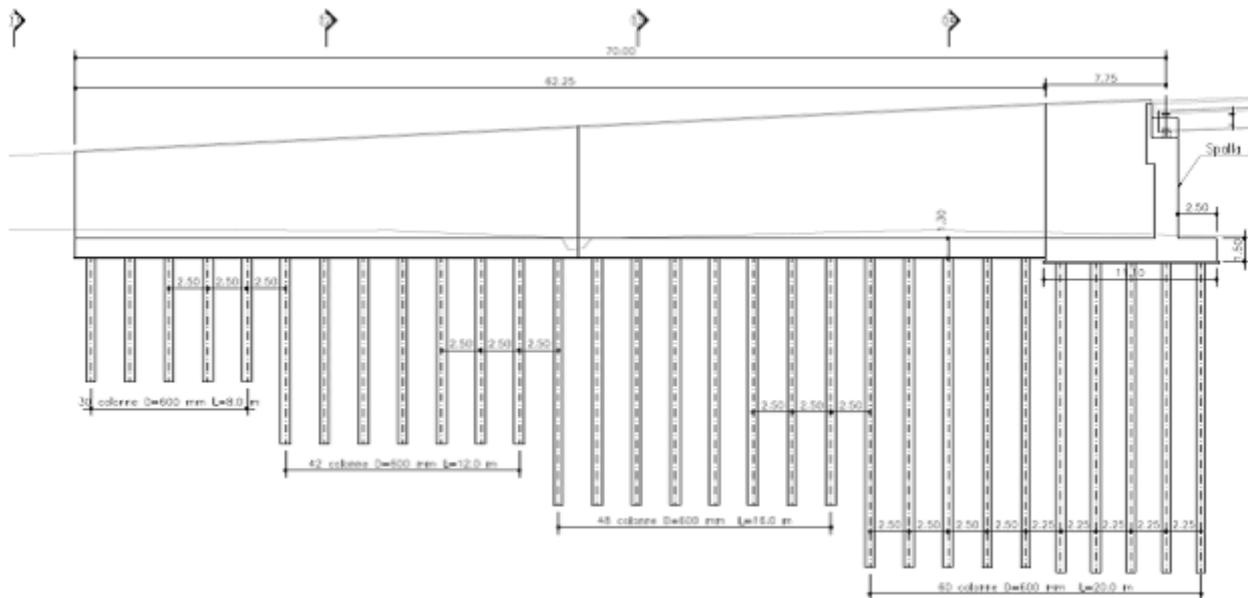
Figura 11-47. Muri a tergo Cavalcavia con trattamento colonnare
