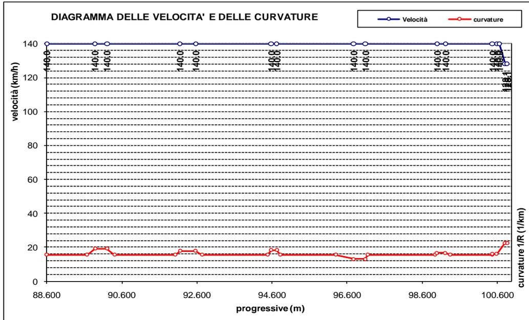
Figura 11-8. Asse Nord di progetto: diagramma delle velocità
