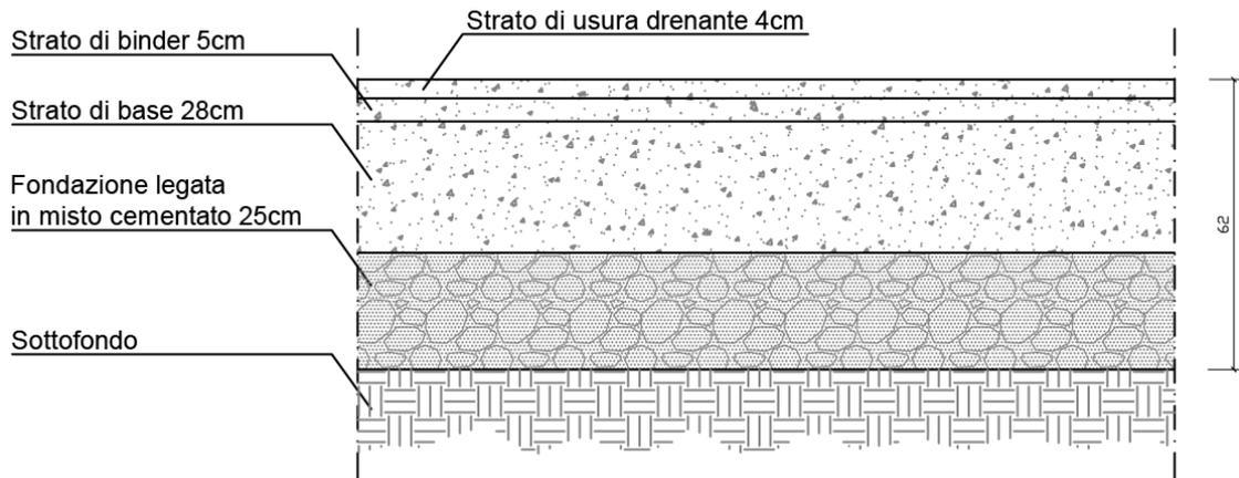
Figura 11-51. Sovrastruttura prevista nei tratti con risanamento RP1 (TIPO 2A)
