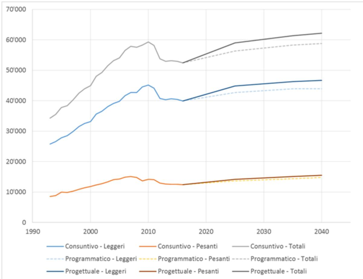
Figura 4-5. Evoluzione del VTGMA sulla tratta autostradale di progetto
