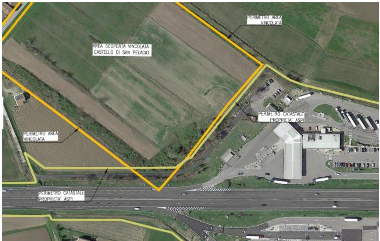
Figura 11-23. Interferenza tra la strada di servizio di accesso all'AdS San Pelagio Ovest e l'area vincolata del Castello di San Pelagio: stato attuale su ortofoto con perimetro catastale
