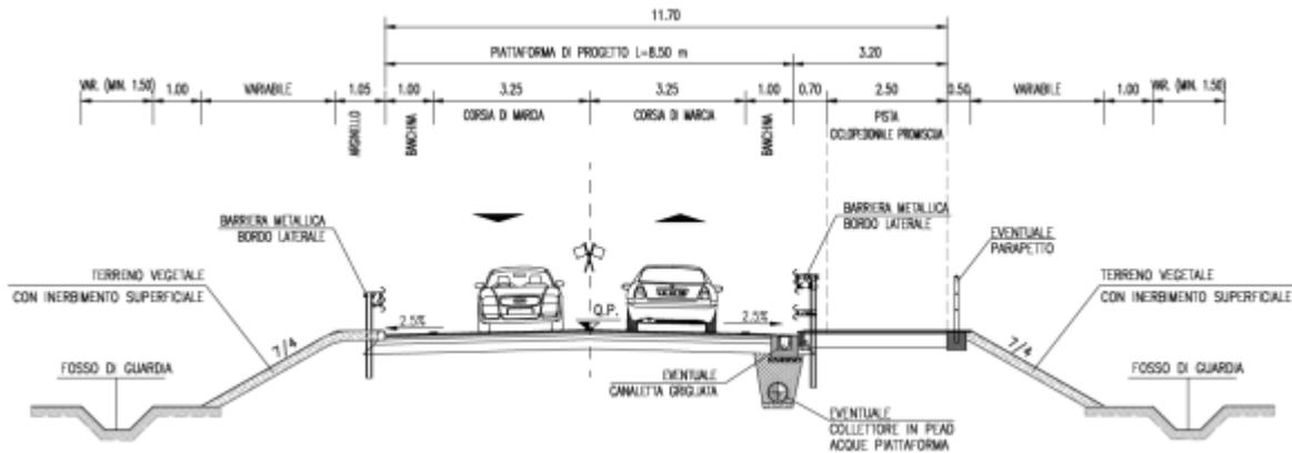
Figura 11-15. Sezione tipo in rilevato – Cat. F2 extraurbana locale
