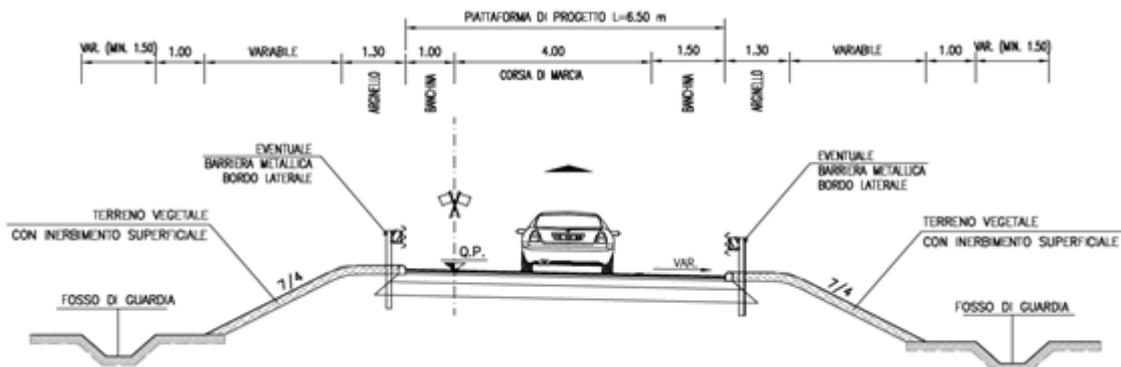
Figura 11-4. Sezione tipo rampa di svincolo monodirezionale
