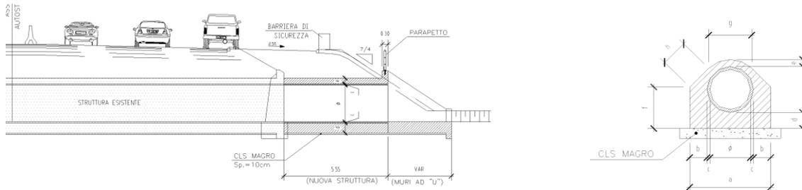
Figura 11-45. Tombini circolari – sezione trasversale e longitudinale
