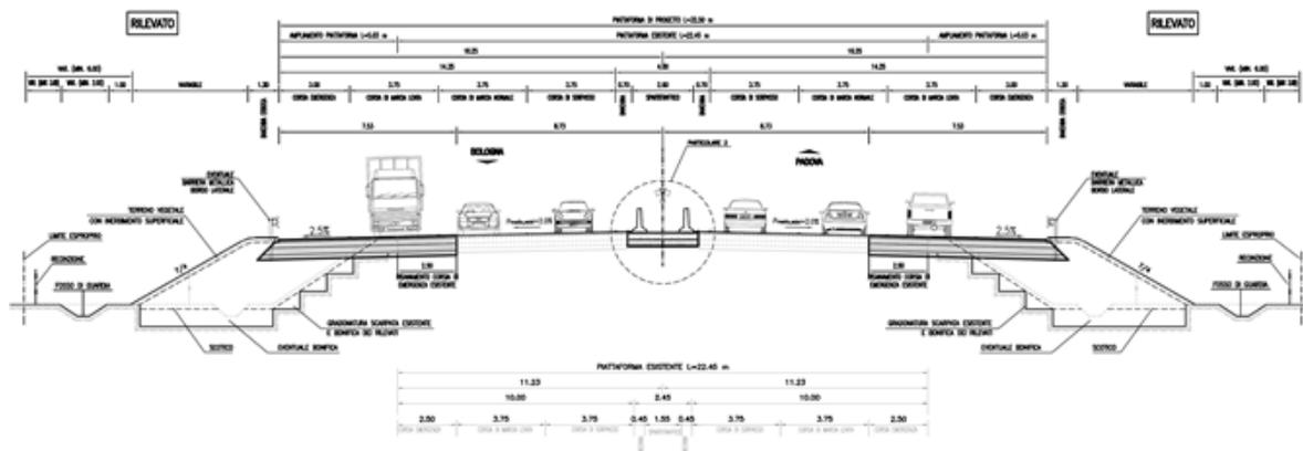
Figura 11-2. Sezione tipo ampliamento simmetrico
