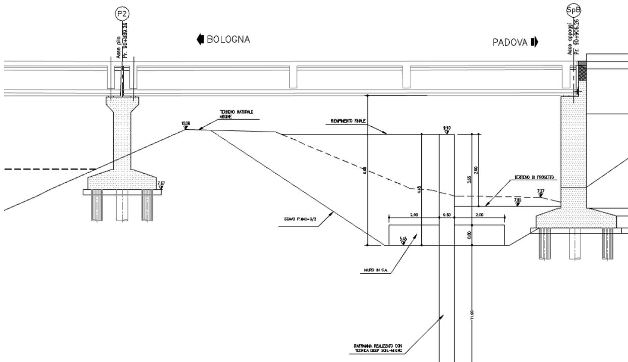
Figura 8-3. Muro in c.a. fondato su setto DSM sotto l'impalcato esistente
