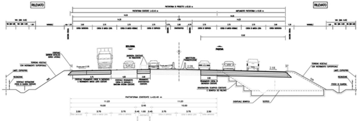
Figura 11-3. Sezione tipo ampliamento asimmetrico
