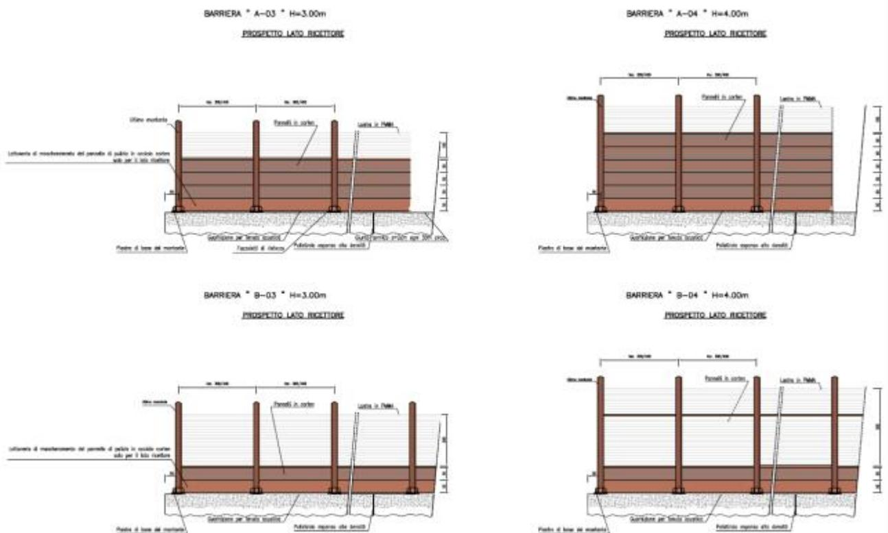
Figura 11-57. Barriere acustiche standard di altezza 3 e 4 m previste nel Progetto Esecutivo, in alto nella tipologia “A” prettamente opaca e in basso nella tipologia “B” prettamente trasparente
