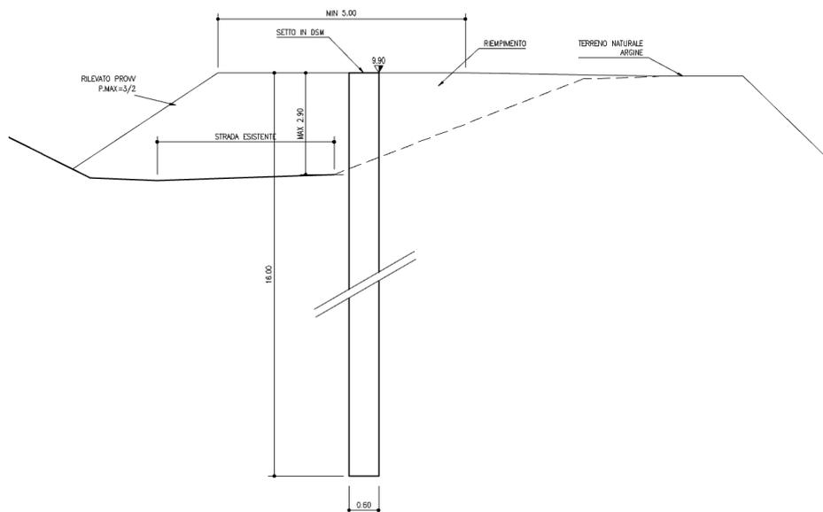
Figura 8-4. Setto DSM fuori l'impalcato esistente
