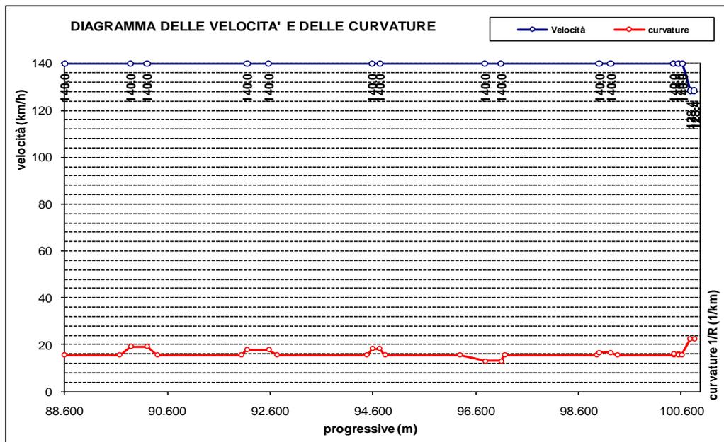
Figura 11-9. Asse Sud di progetto: diagramma delle velocità
