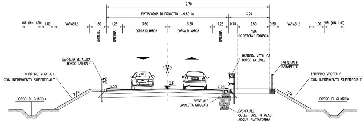
Figura 11-11. Sezione tipo in rilevato – Cat. C2 extraurbana secondaria con pista ciclopedonale promiscua
