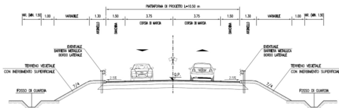
Figura 11-5. Sezione tipo rampa di svincolo bidirezionale
