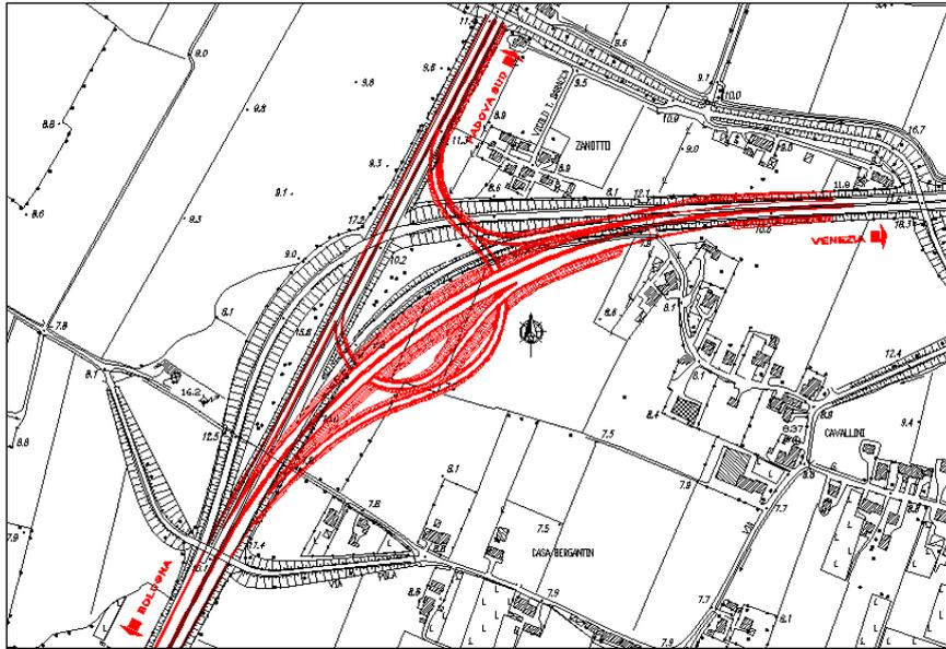
Figura 11-7. A13/Racc. Padova sud - configurazione recentemente realizzata
