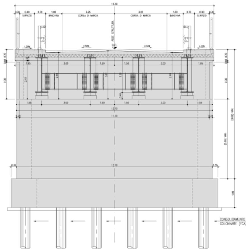
Figura 11-42. Sezione in corrispondenza della spalla
