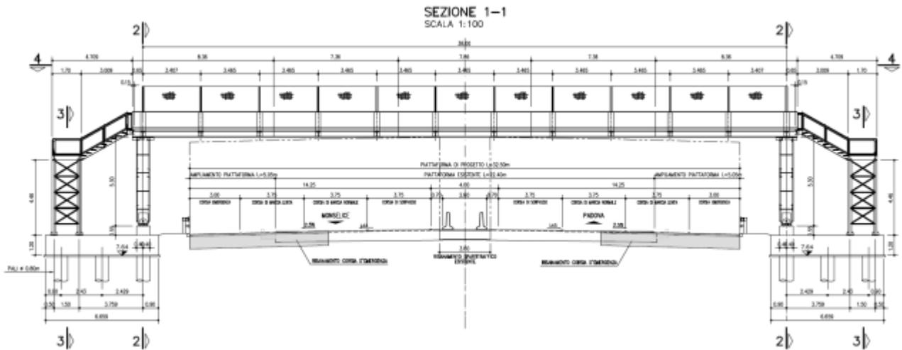
Figura 11-43. Sezione trasversale passerella pedonale
