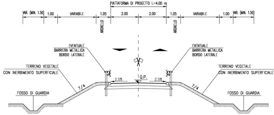
Figura 11-17. Sezione tipo in rilevato – Strada a destinazione particolare
