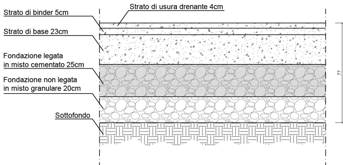
Figura 11-49. Sovrastruttura nuove pavimentazioni (TIPO 1A-1B)
